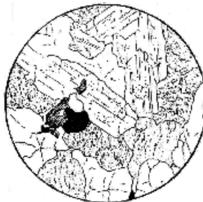
Рис. 9. Гранит. Плагноклаз, калиевый полевой шпат, кварц и биотит; акцессорный магнетит; диаметр поля зрения 4,3 мм (по А. Н. Заварицкому)
